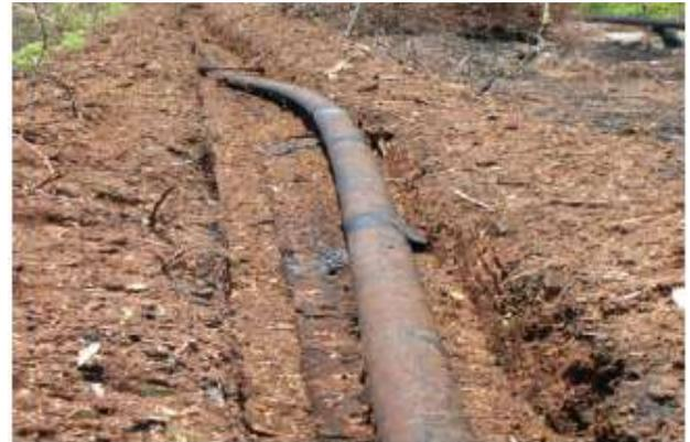
Gambar 1. *Upheaval Buckling* pada pipa penyalur gas akibat kenaikan temperatur<sup>[2]</sup>
