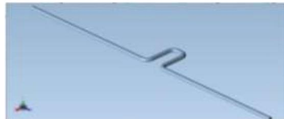
Gambar 10. Model *loop* ekspansi untuk tipe horizontal
